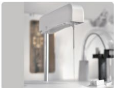
Intelligent probe with optional clog detection Sonda inteligente con detección de obstrucciones opcional
